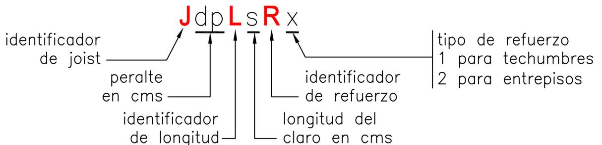
ESTA ES LA NOMENCLATURA ESTANDAR, DESDE LUEGO SE PUEDEN FABRICAR LOS JOISTS CON LA CAPACIDAD DE CARGA, LONGITUD Y PERALTE QUE SE REQUIERA.
