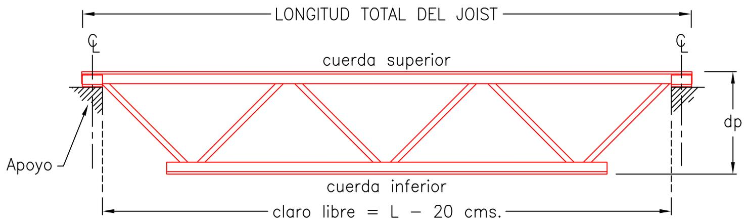
SI TIENE UN CLARO DE 8 MTS. Y REQUIERE UN JOIST PARA TOMAR CARGAS DE ENTREPISO (VEA TABLA 1) CON UNA RESTRICCIÓN EN EL PERALTE DE 45 CMS, EL CODIGO PARA TAL JOIST SERIA J45L800R2
